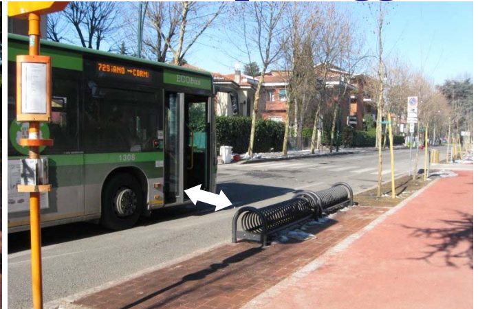
2. Il portabici a lato fermata ostacola salita e discesa dal bus
